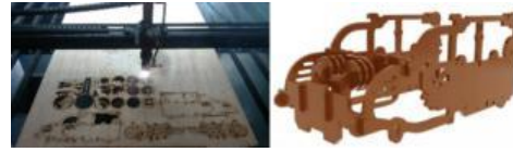
Gambar 9. Model 3 Dimensi sebagai tahap perencanaan dan proses produksi menggunakan cutting laser pada material multipleks (sumber: Riqki Van Gama, 2018)
