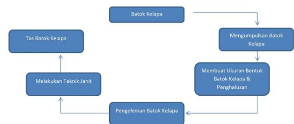
Gambar 8. Proses Teknik Pembuatan Tas Batok Kelapa
