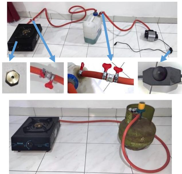
**Gambar 3.** alat uji pertalite (atas), alat uji LPG (bawah)
