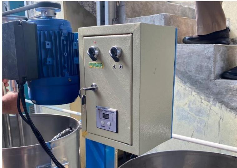
**Gambar 6.** Bagian Panel Kontrol Mesin Pengaduk
