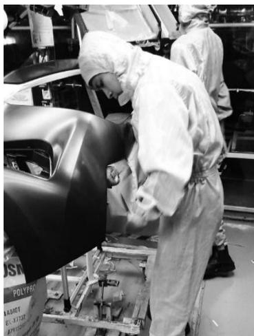
**Gambar 3.** Element kerja Post 2 Pemasangan Masking untuk area *upper front bumper D30D*
