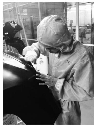
**Gambar 4.** Element kerja Post 3 Pemasangan Masking untuk *rear bumper D30D*
