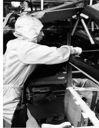
**Gambar 2.** Element kerja Post 1 Pemasangan Masking untuk area *bottom front bumper D30D*
