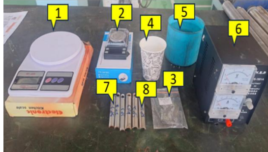
Gambar 2. Alat dan bahan pengujian reduksi material body joint
