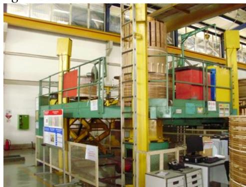
**Gambar 2.** Mesin *winding* vertikal
