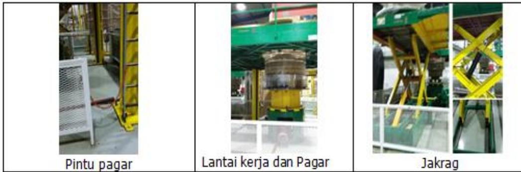
**Gambar 5.** Mekanikal Mesin *Winding* Vertikal
