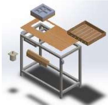
Gambar 4.32 Perakitan Mesin *Vacuum Forming*
