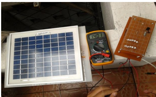
Gambar 12. Koneksi Solar Cell dengan alat ukur
