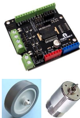
Gambar 2. Modul Rangkaian Penggerak IC L293D, Roda dan Motor DC
