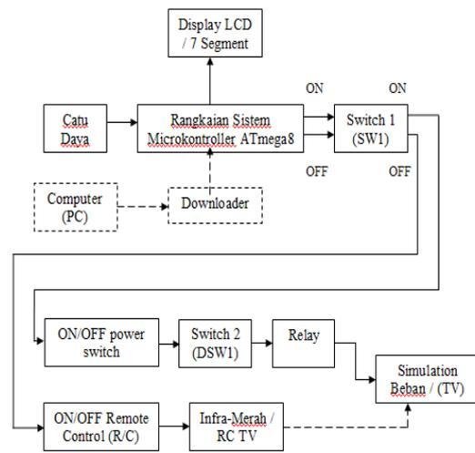
Gambar 5. Blok Diagram Perangkat Keras
