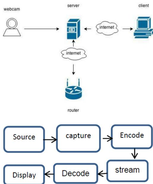
Gambar 6. Blok Diagram dan Alur Proses Kerja Sistem
