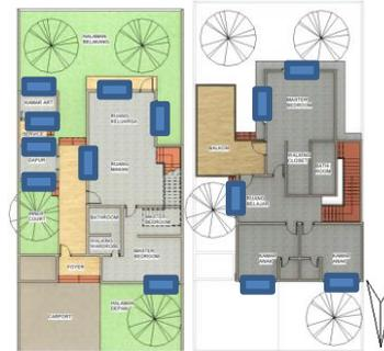
**Gambar 1.** Kiri denah lantai 1, kanan denah lantai 2 hasil desain di *Autodesk Revit 2022*. Berikut dengan penanda bukaan pencahayaan alami (biru).
