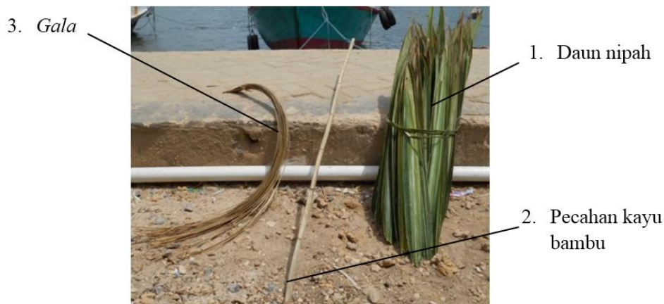
Gambar 2. Bahan-bahan yang digunakan untuk membuat atap daun nipah
