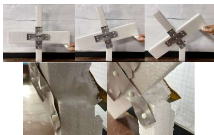
Gambar 5. Dokumentasi Pengujian Sambungan Solid-takik Sumber: Penulis, 2024
