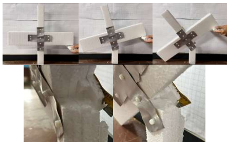
Gambar 5. Dokumentasi Pengujian Sambungan Solid-takik Sumber: Penulis, 2024
