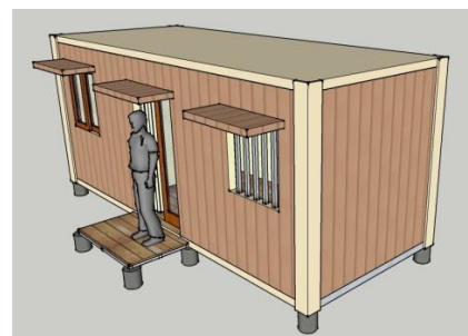
Gambar 3. Penempatan Pondasi Pada Kontainer
